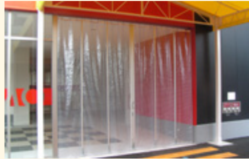
防塵 雨・風除け ビニールシート、ベンダーレール、間仕切ポール使用
