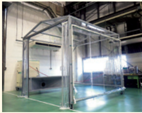
粉塵飛散防止 ビニールシート、D40レール、縦開閉システム使用
