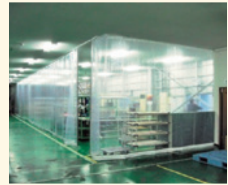
防塵 保温・保冷 ビニールシート、D40レール、間仕切ポール使用
