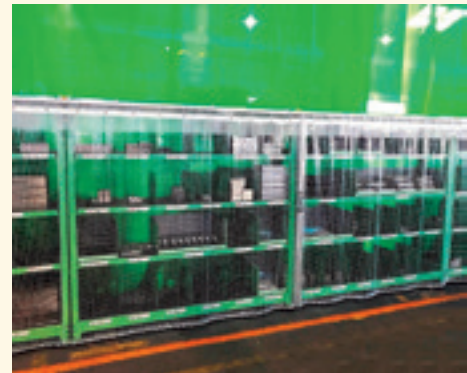
製品棚 防塵 ビニールシート、D30レール、間仕切ポール使用 ⑩
